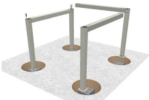
Bauen Sie anschließend einen Träger und einen Stützpfeiler zu einer Ecke zusammen. Hier werden keine Kabel durchgeführt. Setzen Sie diese Konstruktion auf den nächsten Fundamentsockel und verbinden Sie sie mit dem bereits aufgestellten Bogen. Dies ist der hintere Träger des Systems.
