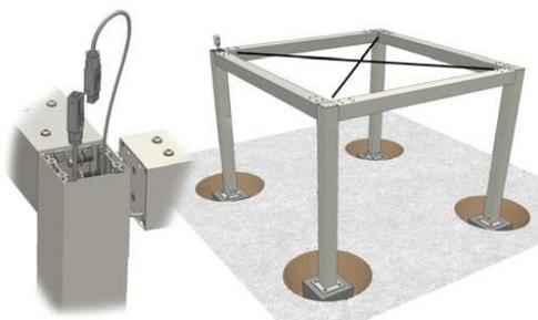
Befestigen Sie mit den 6kt-Schrauben M8x30 den Frontträger mit der Senkrechtmarkise zwischen die beiden vorderen Stützpfeiler. Führen Sie dabei das Motorkabel durch die Bohrung im Stützpfeiler. Verbinden Sie die beiden Stecker des Bedienkabels und führen Sie diesen in den Stützpfeiler.
