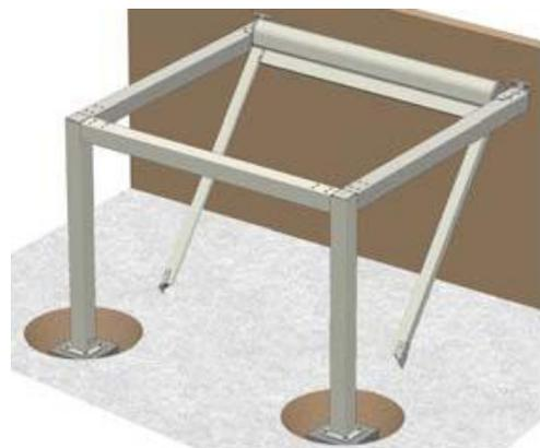
Schieben Sie die Führungsschienen auf die Seitenlager und legen Sie diese kurz auf dem Boden ab.
