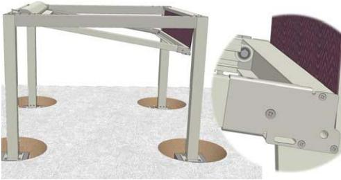
Fahren Sie die vordere Senkrechtmarkise aus und heben Sie die Führungsschienen an das Ausfallprofil.
