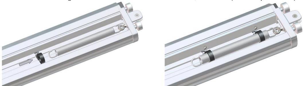
11. Markieren Sie mit den Aufkleber die maximale Ausdehnung der Feder in dem Fallprofil. Eine Feder kann bis zu 60% seiner ursprünglichen Länge gespannt werden. Bei kürzer Feder (Länge 35 cm), kleben Sie die rote Linie auf dem Aufkleber auf 56 cm ab die Seiten des Fallprofils. Bei lange Feder (Länge 57 cm), kleben Sie die rote Linie auf dem Aufkleber auf 91 cm ab die Seiten des Fallprofils.
