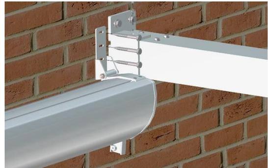
20. Kippen Sie die Kassette und zeichnen Sie die Löcher ab. Bohren Sie Löcher für die Befestigungen. Lassen Sie sich dabei gegebenenfalls von Ihrem Befestigungsmittellieferanten beraten. Drehen Sie die Schrauben in der Wand.
