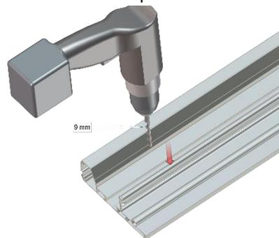
3. Bohren Sie mithilfe der Bohrschablone, Löcher von 6,5 mm im Abstand von 500 mm in der Nut des Fallprofils. Achten Sie darauf dass in der Mitte des Fallprofils einem Abstand von  $\pm 700$  mm ist. **Achtung:** Der Abstand von 700 mm wird als Bewegungsraum für die Kordelspanner beim Öffnen und Schließen benötigt.
