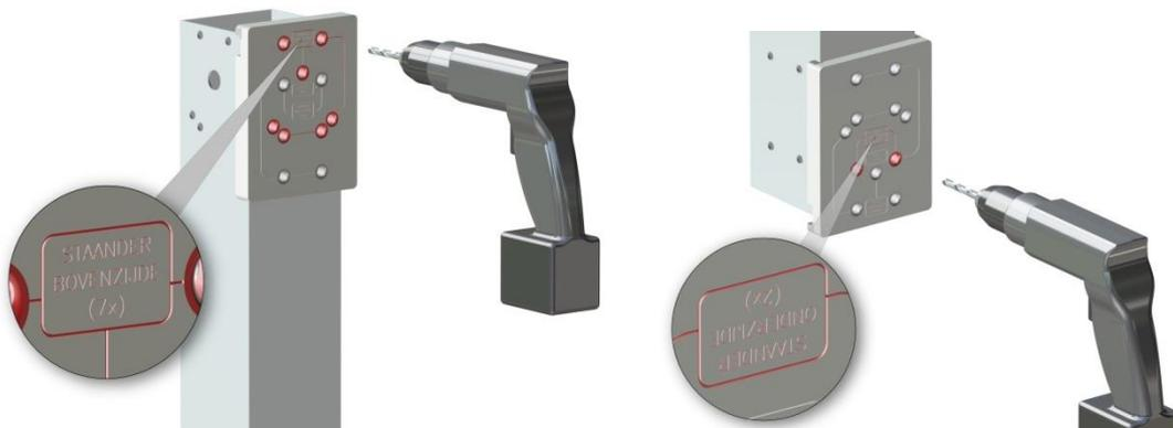
7. Montieren Sie den Stellfuß der Montageplatte mit abgewinkelte Senkkopfbolzen an dem Montageprofil
