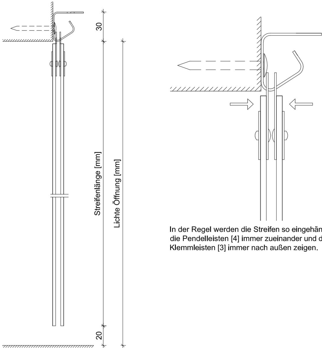
In der Regel werden die Streifen so eingehängt, dass die Pendelleisten [4] immer zueinander und die Klemmleisten [3] immer nach außen zeigen.
