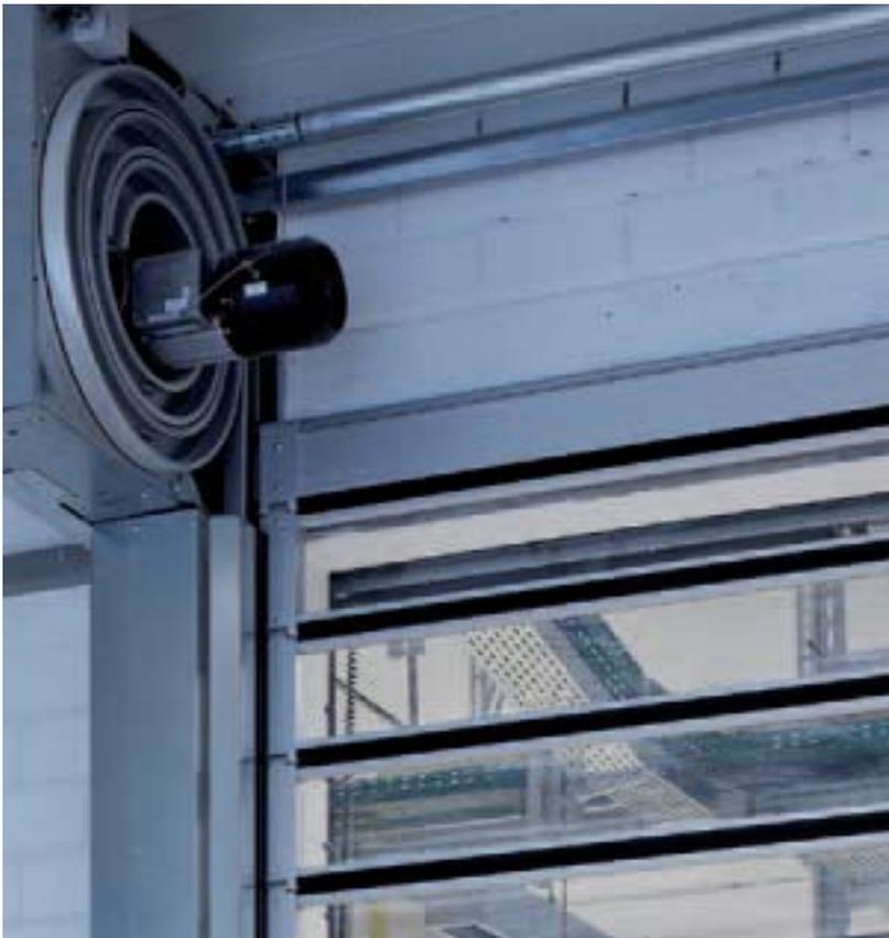
*Die Lamellen sind beidseitig mit groß dimensionierten Scharnierbändern verschraubt. Die Führung der Lamellen erfolgt über besonders leicht und leise laufende Rollen. Innerhalb des Torblatts wirken somit weder Antriebs- noch Übertragungskräfte.*
