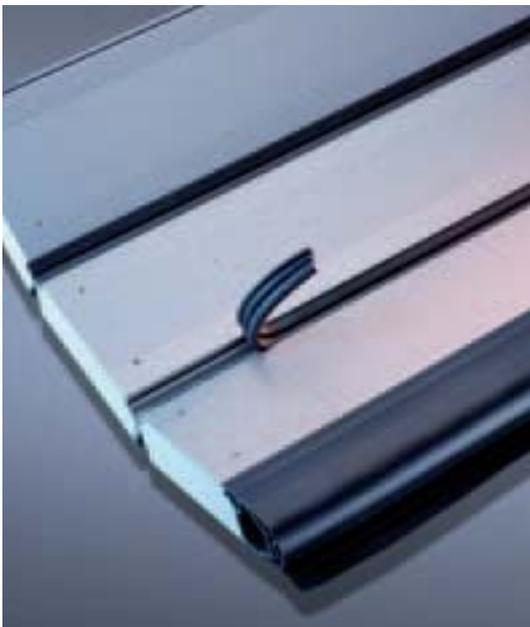
*Sämtliche Gummidichtungen zwischen den SOLARMATIC®-Lamellen sind in aufwendiger »Clip«-Technik eingebaut. Selbst wenn eine oder mehrere Lamellen fehlen, kann der Rollladen weiter betrieben werden.*
