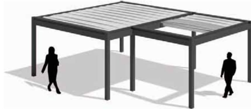
Selbsttragende Struktur Nomo oder Rialto, welche durch Kombination von zwei Modulen mit unterschiedlichen Tiefenmaßen hergestellt wird
