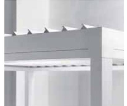
Die Lamellen von Opera und Vision können ferngesteuert von 0° bis 140° in vier voreingestellten Standardpositionen oder beliebigen Zwischenpositionen geöffnet werden, wobei das Sonnenlicht moduliert und der Luftfluss geregelt wird.
