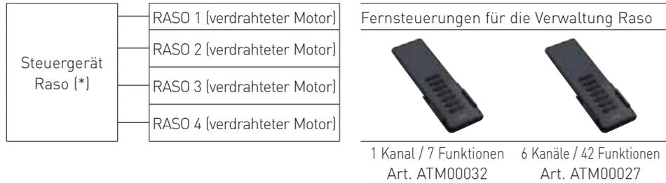
(\*) jedes Steuergerät kann maximal 4 Schließungen Raso steuern
