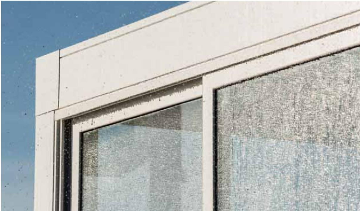
Die bioklimatischen Lauben Opera und Vision wurden auf einer Wasserundurchlässigkeitprüfung (System mit Lamellen, Traufen und Ablässe) durch die Techniker des Istituto Giordano unterzogen (Probebericht Nr. 319934).
