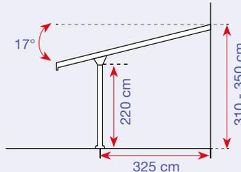
Anpassungsfähige Montage durch variable Firsthöhe und verstellbare Trägerpfosten
