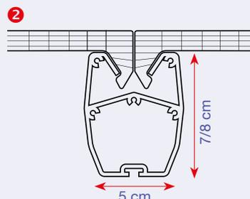
10 mm starke Polycarbonat Hohlkammerplatten werden in den Sparren eingeklickt
